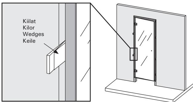
**6.** Kun karmit on kiinnitetty ruuveilla, tarkista vielä että karmit ovat suorassa ja ovi käy hyvin. Tiivistä oven ja seinän väli. Saha tarvittaessa kiilat karmien ylitäväältä osalta (saha pystyasennossa). Poista alatuut ja karmien tukirima. Asenna listat ja kahva.
